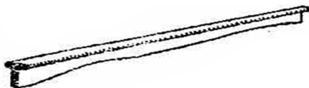
Рис. 8. Рельс с рыбообразным утолщением
