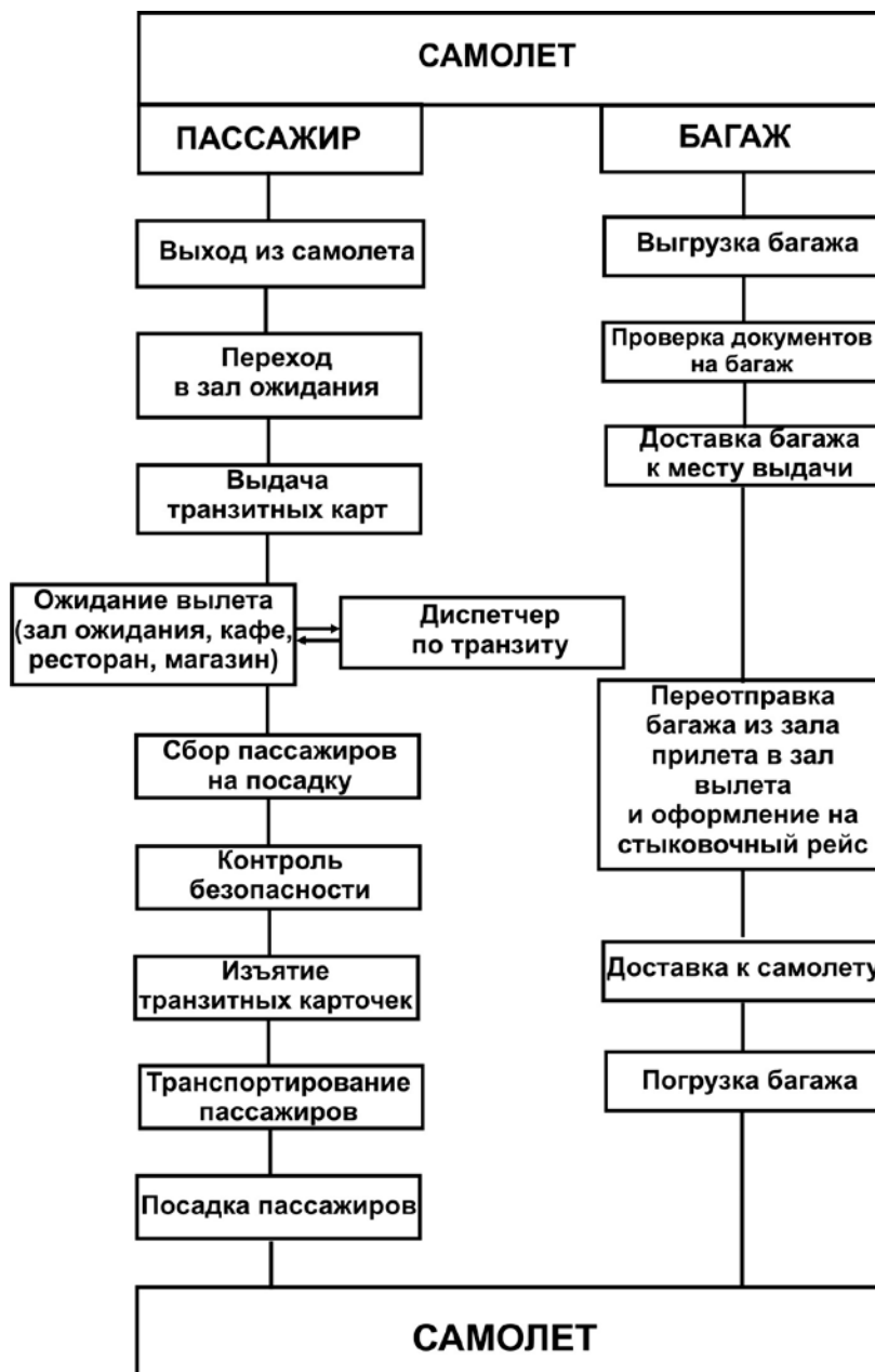
Рис. 3. Схема обслуживания трансферных пассажиров с кратковременной остановкой
