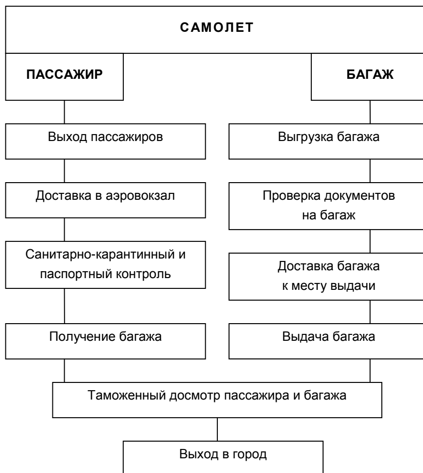
Рис. 2. Схема обслуживания пассажиров, прилетевших в конечный пункт
