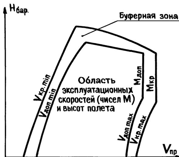
Рис. 3.4. Область эксплуатационных скоростей ЛА в зависимости от высоты полёта
