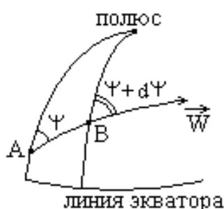
Рис. 1.7. К определению изменения курсового угла при полете по ортодромии
