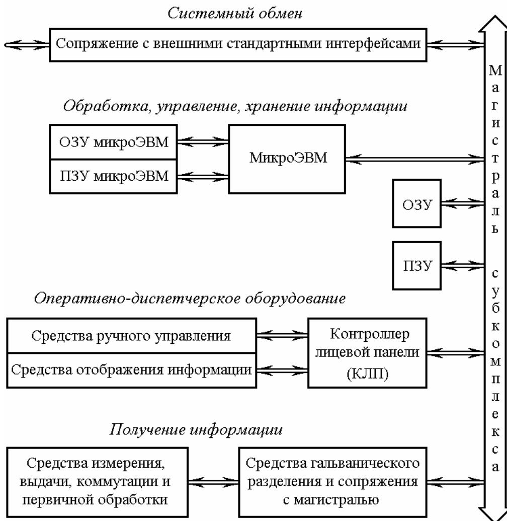
Рис. 1. Обобщённая структура субкомплекса
