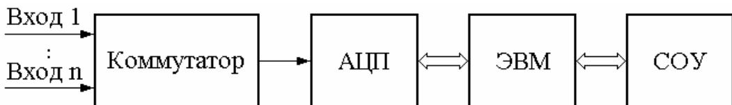
Рис. 4.7. Упрощённая структурная схема микропроцессорной навигационной системы: АЦП – аналого-цифровой преобразователь; ЭВМ – электронная вычислительная машина; СОУ – система отображения информации и управления
