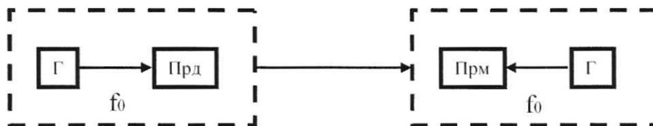
Рис. 92. Автономная синхронизация
