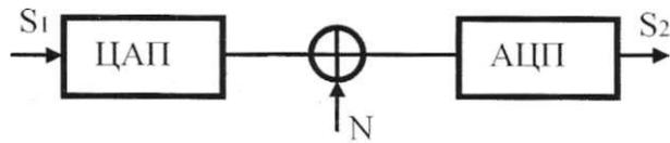
Рис. 49. Искажения сигналов при АЦП
