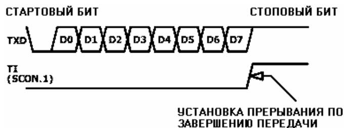
Рис. 1.31. Временная диаграмма формирования прерывания по завершению передачи
