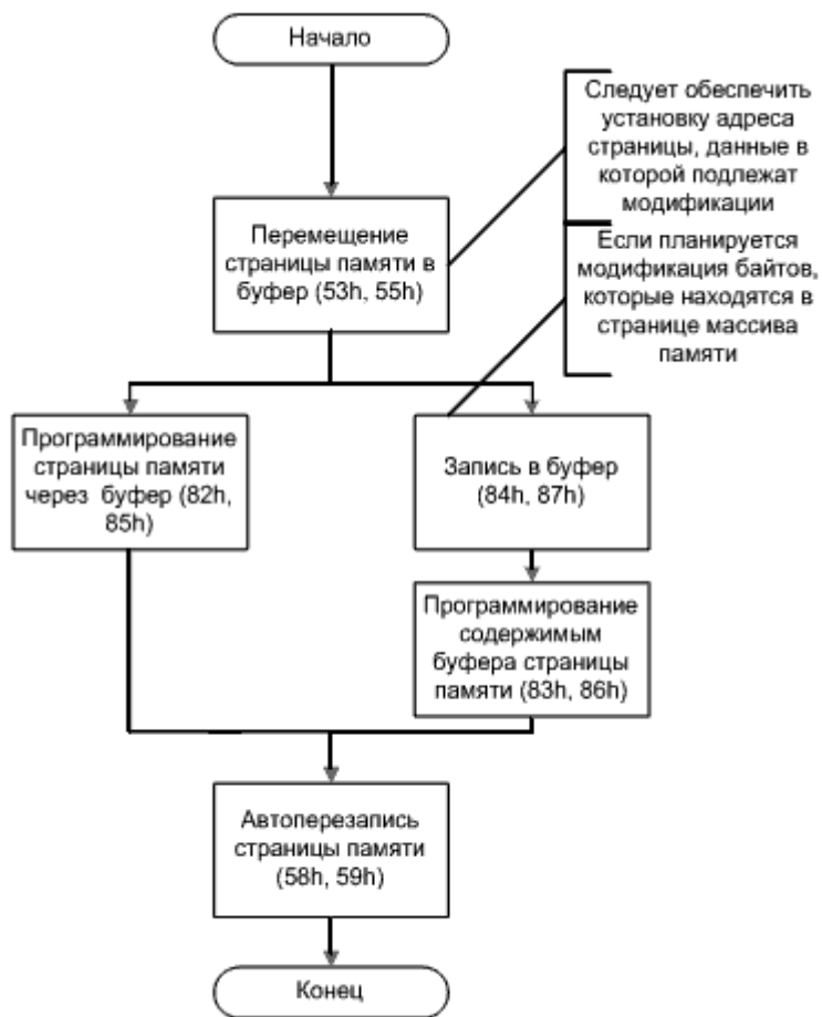
Рис. 3.9. Алгоритм модификации данных в DataFlash
