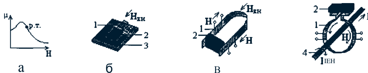
Рис. 2.8. Конструктивные варианты магнито-индуктивных датчиков: 1-магнитопровод с катушкой индуктивности, 2-постоянный магнит, 3-плата, 4-проводник с током
