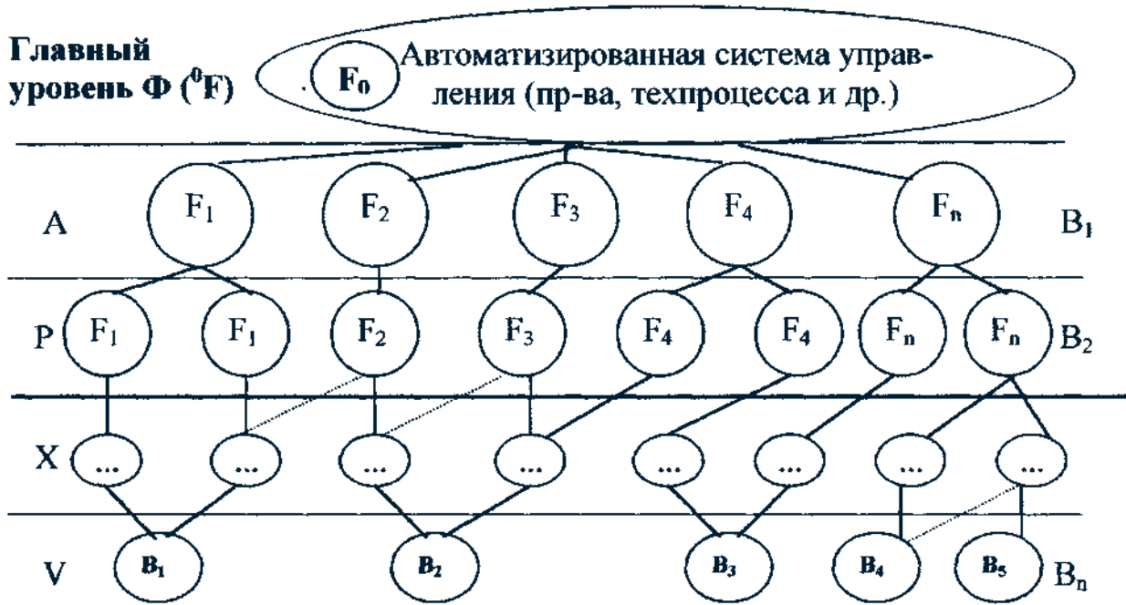
Рис.3. Схема графа основных компонент автоматизированной системы проектирования по уровням иерархии: ( V_j - B^{\wedge} - блоки информации - информационные комбинаторные блоки (файлы), F_j - функциональные уровни
