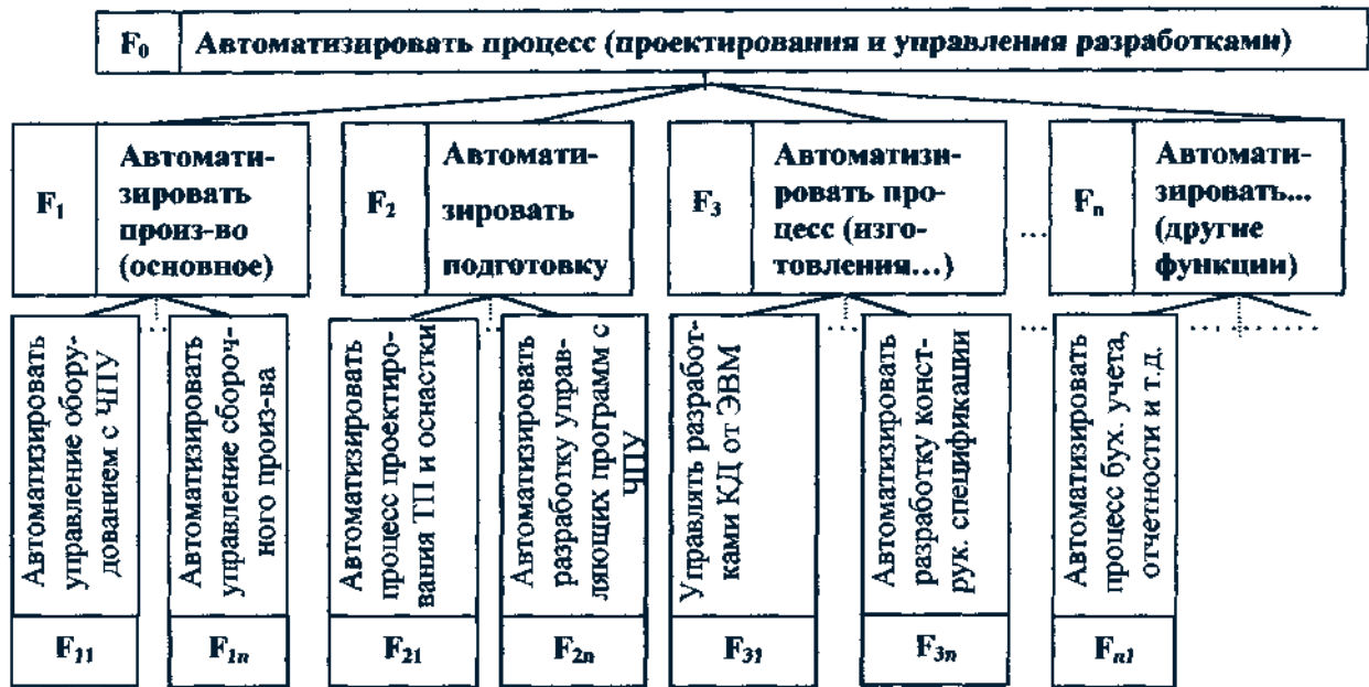
Рис.2. Функционально-структурная модель автоматизированного управления производством (предприятием) с позиции функционального подхода
