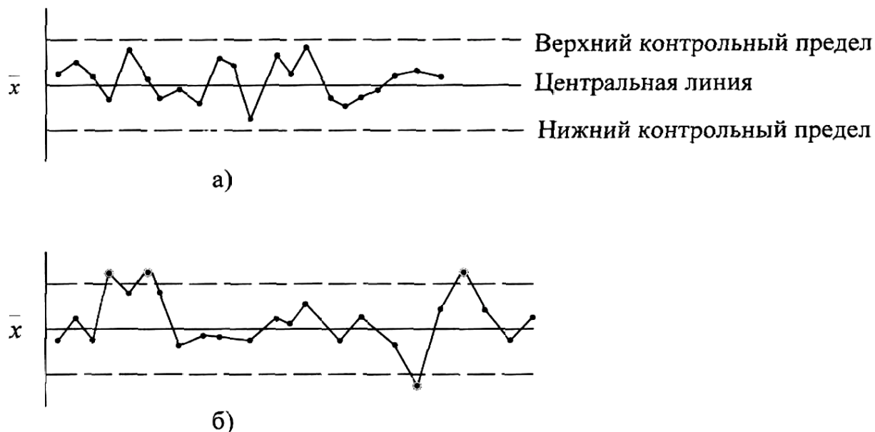
Рис. 10.14. Примеры контрольных карт: а) – управляемое состояние процесса; б) – неуправляемое состояние процесса
